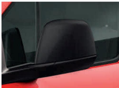
Rétroviseurs à réglage électrique et chauffant (de série sur Trend)
