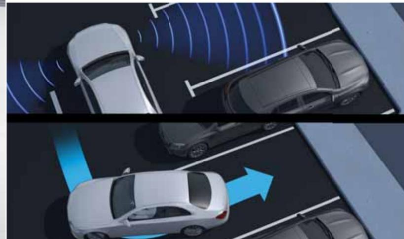
Aide au parking active PARKTRONIC avec capteurs à ultrasons avant/arrière
