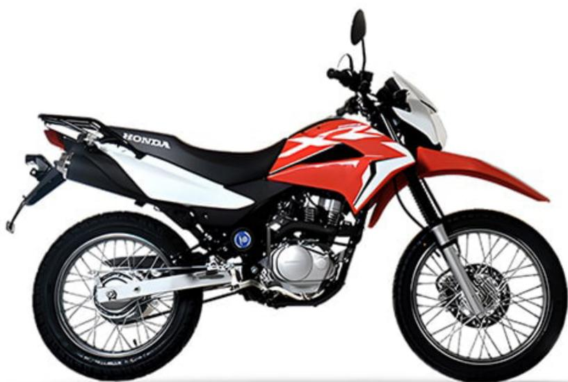
Démarrant d'une simple pression sur la commande du démarreur électrique, le robuste monocylindre 4 temps de 125 cm<sup>3</sup> se révèle à la fois performant et très économique (environ 3.4L/100km). Le cadre a été dessiné pour affronter le tout-terrain et dispose de ce fait de confortables suspensions qui assurent un comportement efficace sur route comme hors du bitume, tout en permettant de poser les pieds au sol avec facilité.
